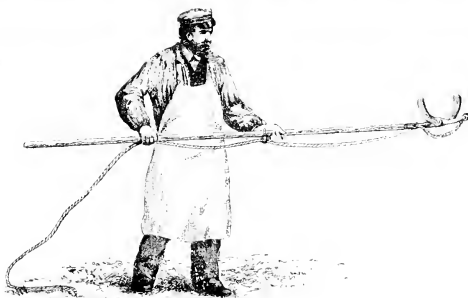
Fig. 2. — Appareil monté et en position pour capturer une bête à bois ou à cornes.
